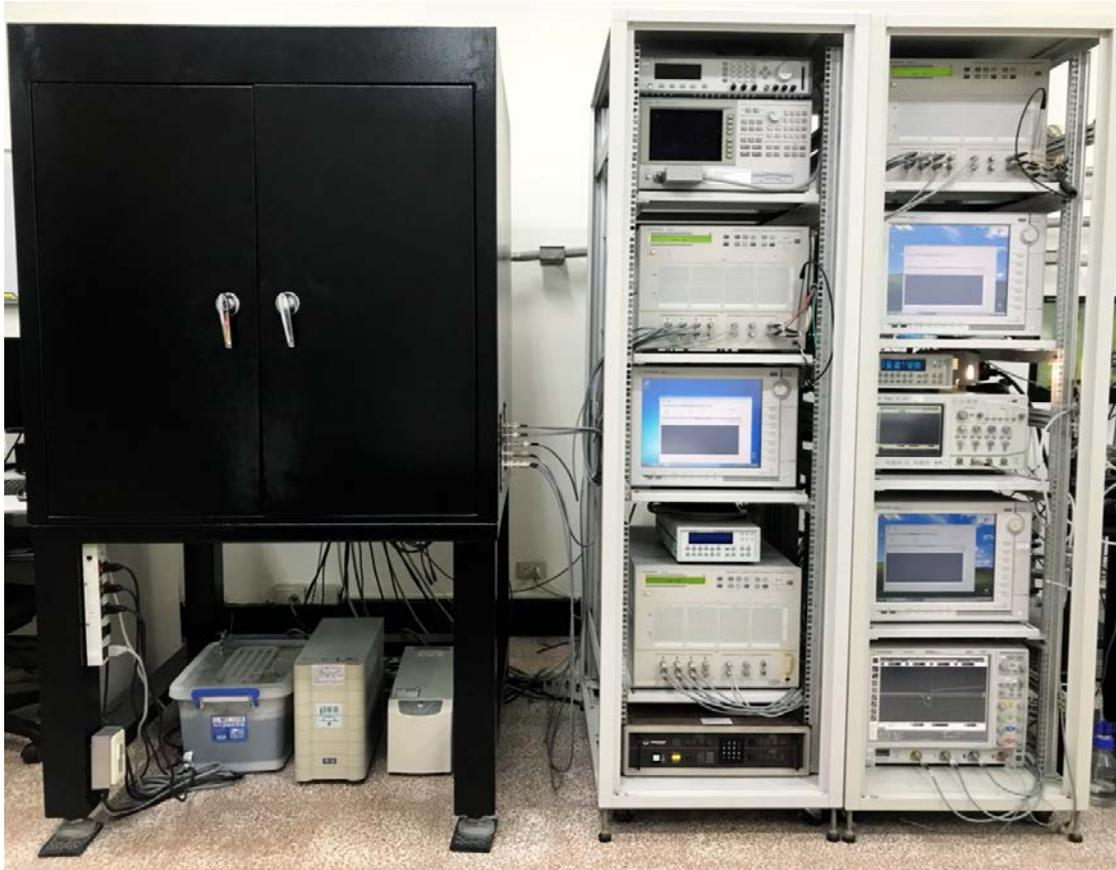
本量測系統適用於半導體電子材料、奈米元件之電性量測 (I-V、C-V)，並且附加溫控系統做溫度調變，可用來分析電子元件之可靠度和電性機制。本平台提供 RT~473K 之變溫量測環境及 1kHz~5MHz 之變頻量測，及提供照光 (紅、綠、藍、UV)下量測，且最多 4 端點元件之量測。並可由 Agilent B1500A 半導體參數分析儀，量測在不同溫度和照光下的元件特性及可靠度，更能釐清其中的物理機制，是研究分析電性不可或缺的利器。整個系統利用 Agilent Desktop EasyExpert 量測軟體進行自動控制，提供方便且迅速的量測功能。
